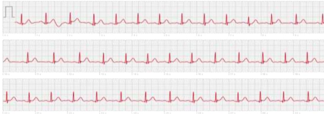
25 mm/s, 10 mm/mV, Elettrodo I, 512Hz, iOS 16.4, watchOS 9.3, Watch6,16, Versione algoritmo 2 - L'andamento della forma d'onda è simile a quello di un ECG di tipo "Derivazione I". Per ulteriori informazioni, consulta le istruzioni d'uso.
